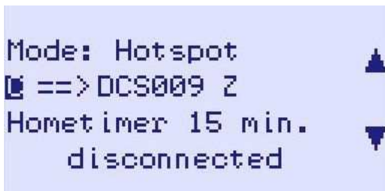
Rys. 23. Punkt dostępowy – wybrany moduł C ma służyć do połączenia z reflektorem DCS009Z
