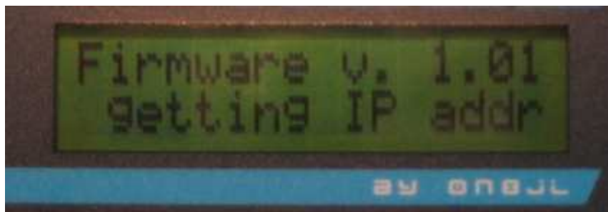
Rys. 2. Wyświetlacz w trakcie pobierania adresu, u góry informacja o wersji oprogramowania
